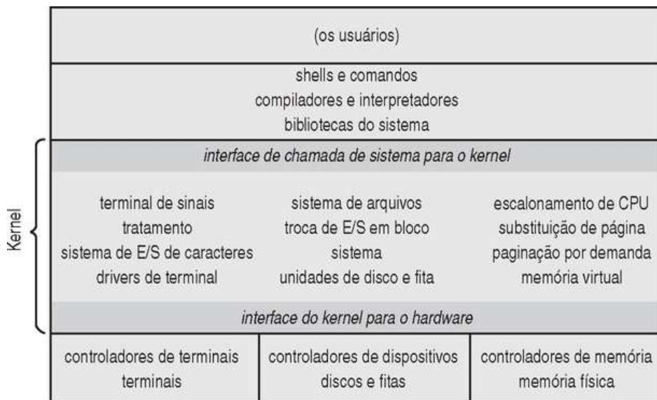
FIGURA 2.13 Estrutura do sistema UNIX tradicional.
