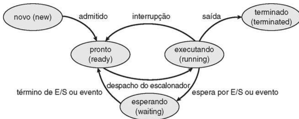
FIGURA 3.2 Diagrama de estado do processo.
